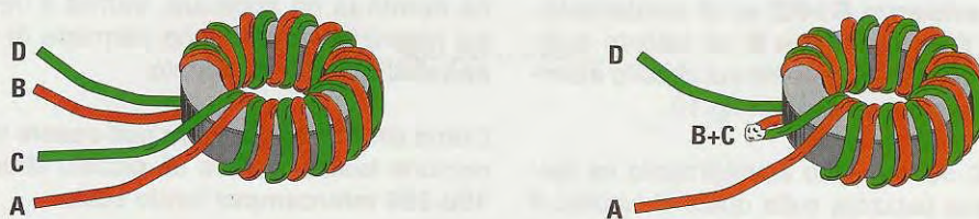
Fig.4 Il trasformatore siglato T1 si ottiene avvolgendo sul nucleo toroidale incluso nel kit, 10 spire utilizzando un filo bifilare. Il filo d'inizio A va collegato alla pista di R2-R1 e il capo terminale B alla pista visibile nelle figg.7-10 insieme al capo d'inizio C del secondo avvolgimento. Il capo terminale D va collegato alla pista di R3-R4.
