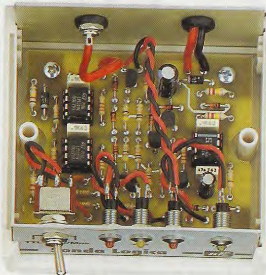
Fig.10 Il circuito stampato va fissato con 3 viti autofilettanti all'interno del mobile plastico, che forniamo completo di mascherina forata e serigrafata (vedi fig.1).
