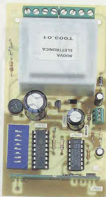
Fig.11 Ecco come si presenta a montaggio ultimato lo stadio trasmettente. Le leve del micro-switch S1 vanno posizionate nel medesimo modo di quelle del ricevitore.
