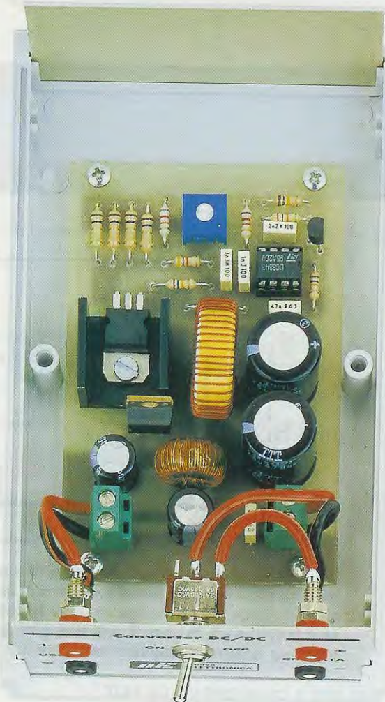
Fig.5 Dopo aver montato sul circuito stampato tutti i componenti, dovrete inserirlo all'interno del suo mobile plastico che vi forniremo con il pannello frontale già forato e serigrafato. Prima di fissare le 4 boccole dovrete sfilare la loro rondella plastica posteriore che inserirete sulla parte interna del pannello.
